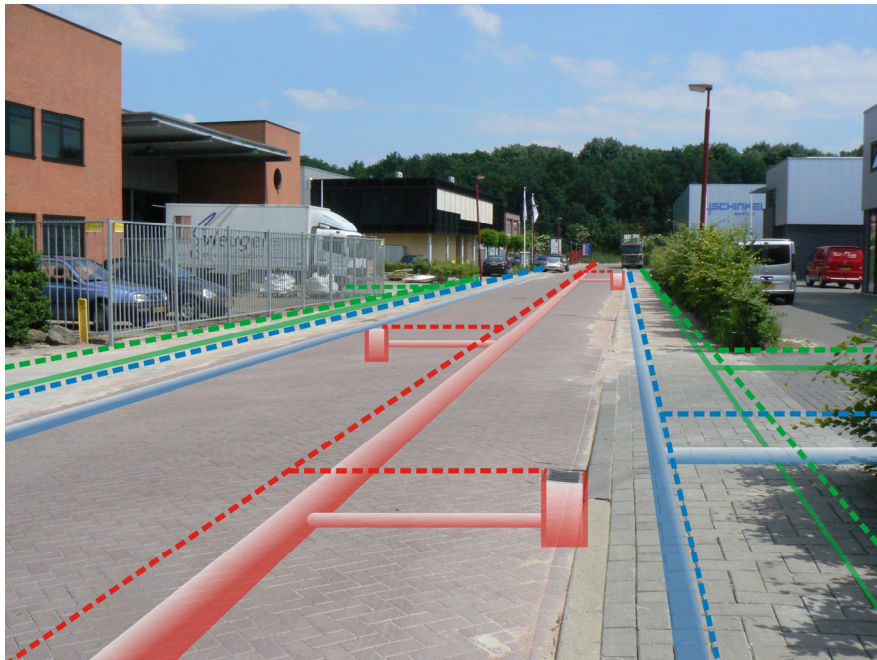
Afb. 1: De ligging van kabels en leidingen, zoals te zien door een augmented reality bril.
